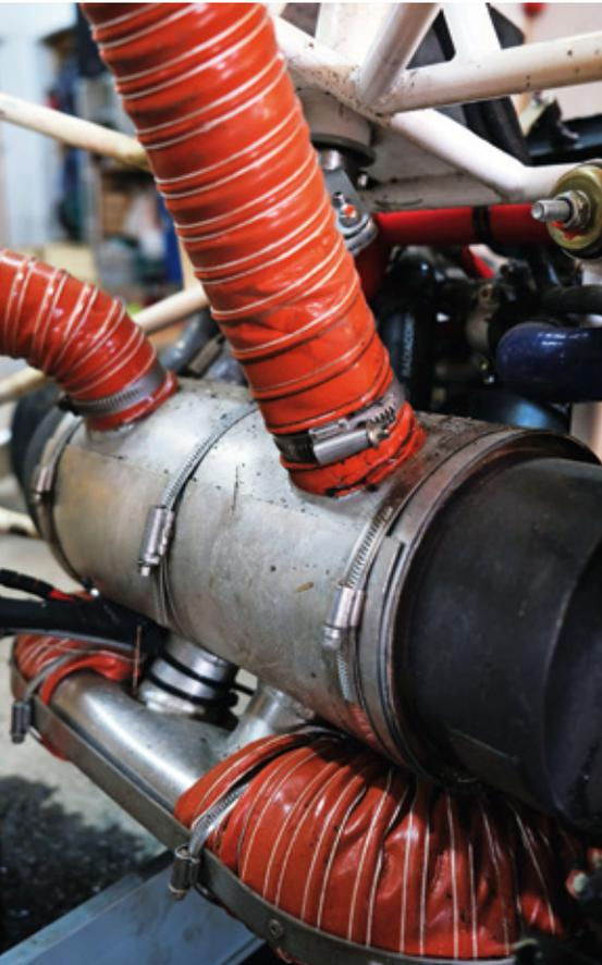
Ein typischer Wärmetauscher bei luftgekühlten Flugmotoren: Dabei wird die Luft, die das Cockpit wärmen soll, um die heißen Bauteile des Abgassystems geführt. Undichtigkeiten im Abgassystem können dabei die spätere Heizungsluft vergiften
