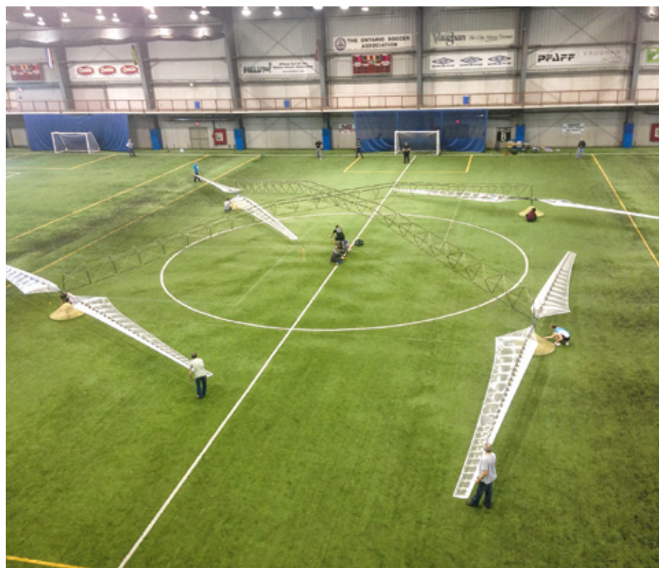
Kurioses Konstrukt: Ein kanadisches Geschwisterpaar brachte 2013 einen durch ein Fahrrad angetriebenen Hubschrauber in die Luft
