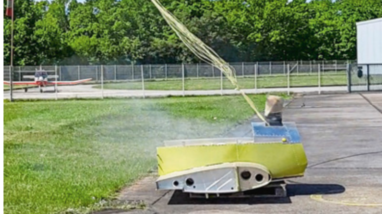
Während des Ausschusstests wirken starke Kräfte auf das Material
