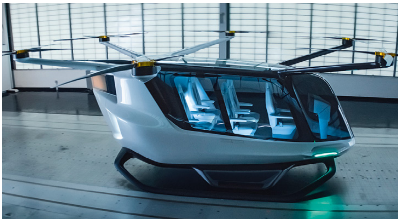
Skai ist das erste Flugtaxi mit Brennstoffzellenantrieb
