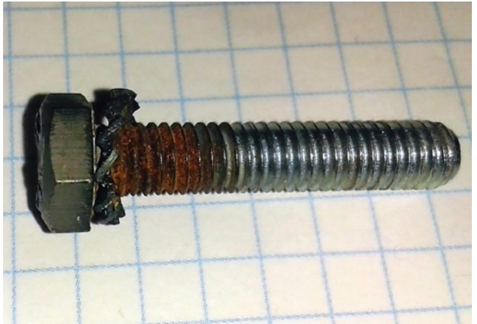
Auch bei nicht richtig gewarteten Elektroantrieben lauern Gefahren: Das Bild zeigt einen wegen hoher Ströme ausgeglühten Schraubenkopf
