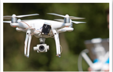
Eine Drohne mit entsprechender Ausstattung für das UTM-System der DFS
