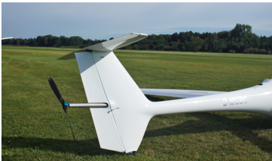
Eine Welle treibt einen faltpropeller mit 1,30 Meter Durchmesser an, der sich im Segelflug automatisch nach hinten widerstandsarm zusammenklappt
