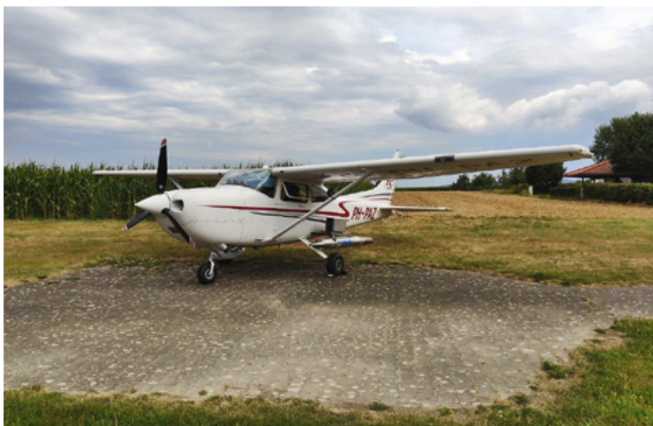
Die Hagelabwehr-Cessna 182 mit Silberiodid-Generatoren und -Batterien am Rumpf
