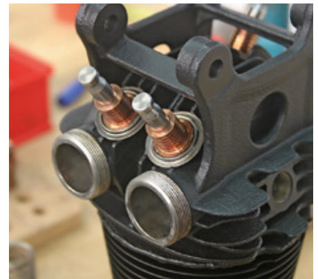
Einer der beiden Zylinder des Boxermotors. Beide haben einen Hubraum von 884 ccm und verhelfen dem Leichtflugzeug zu 16 kW Leistung
