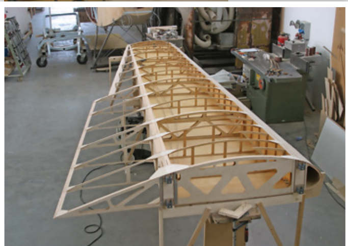
Holz-Leichtflugzeugbau vom Feinsten: Der zweiholmige Flügel der L20 vor der Bespannung
