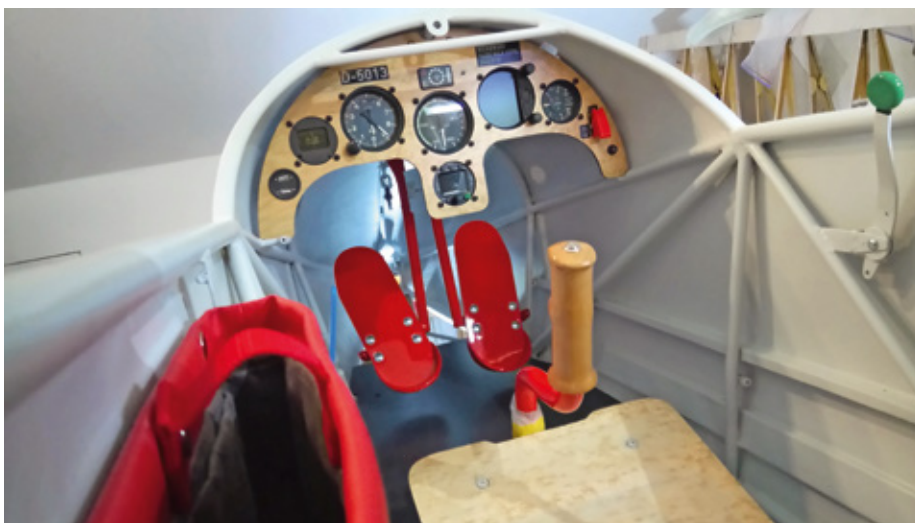
Die Original-Instrumente wurden überholt und sind nun wieder wie neu
