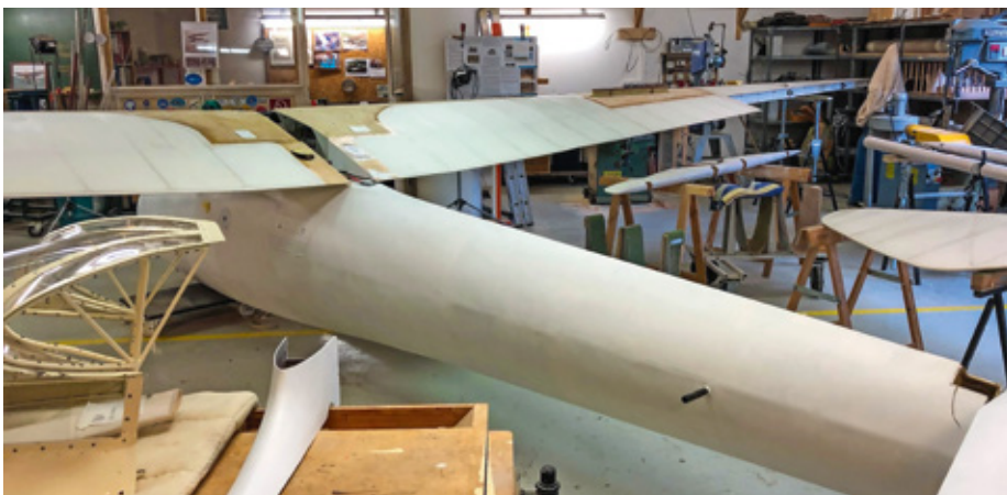
An der Meise musste enorm viel repariert werden – sie kam in einem sehr schlechten Zustand im Museum an
