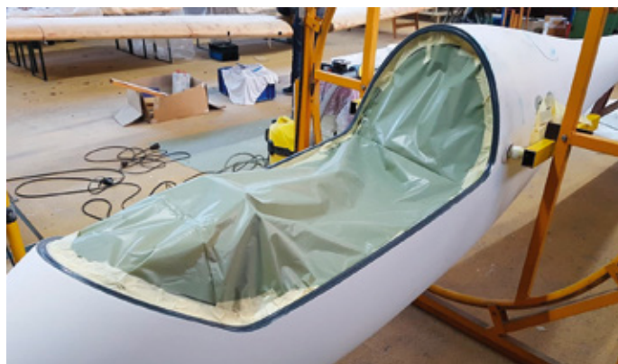
Die Haube ging bei den Instandsetzungsarbeiten kaputt und musste erneuert werden
