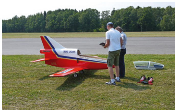
Die Abnahme beinhaltet neben diversen Sichtkontrollen den Belastungstest bei Flächenmodellen, die Lärmmessung und zwei Abnahmeflüge.
