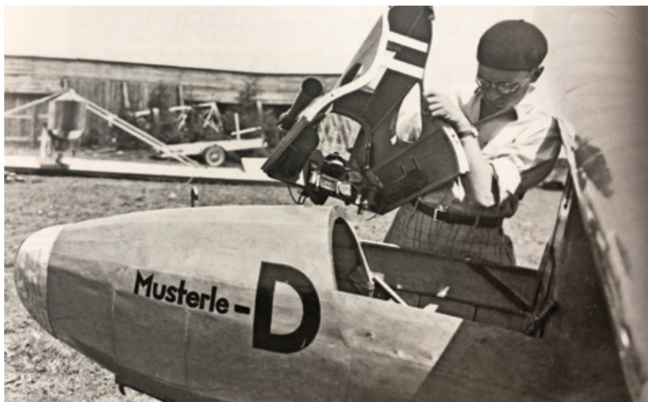
Mit dem Musterle erfliegte Wolf Hirth über Jahre viele Rekorde. In die abnehmbare Haube waren alle wertvollen Fluginstrumente eingebaut
