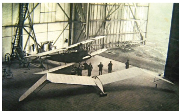
1920 in der Zeppelinhalle in Baden-Oos: Der in Baden-Baden gebaute schwanzlose Segler „Feldberg“ von Friedrich Wenk und Fritz Peschkes
