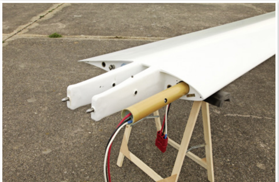
Die Akkustangen von je etwa elf Kilogramm Gewicht werden in Röhren aus Kevlar von 2,6 Meter Länge in den Flügel geschoben
