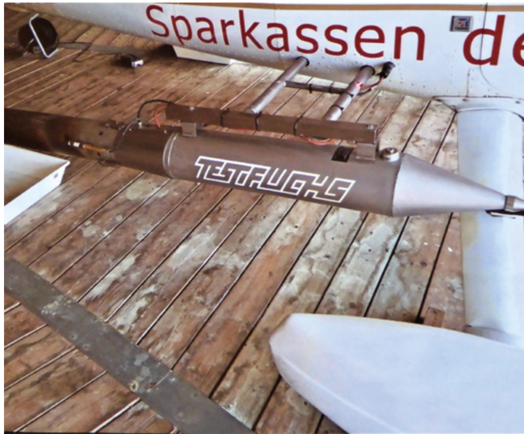
Mit einem speziellen Rauchgasgenerator wird eine Silberjodid-Aceton-Lösung verbrannt. Diese verhindert die Bildung von großen Hagelkörnern in der Wolke
