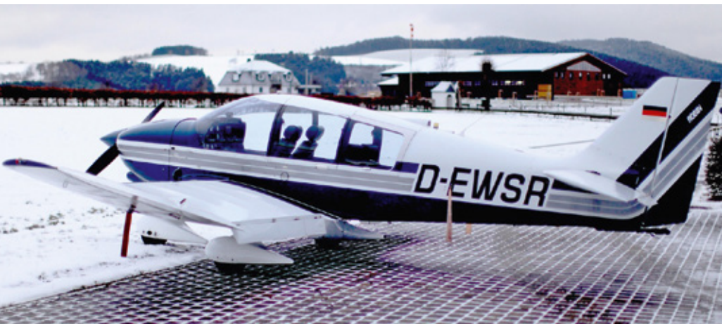
Nicht nur im Winter: Stauraehr und Öffnung für den statischen Druck sichtbar verschlossen
