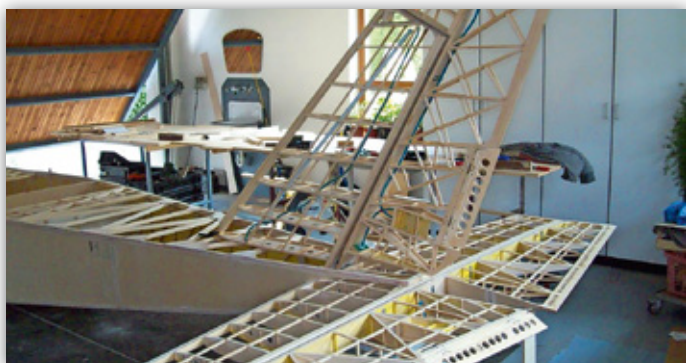
Das Leitwerk im Rohbau
