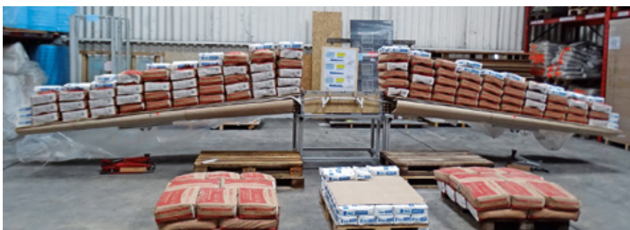
Der Belastungstest für die Flügel mit 1,1 Tonnen je Flügelseite war eine harte Probe für Flugzeug und Erbauer
