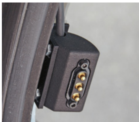
Der Notabwurf der Haube wird durch die Bauteile nicht beeinträchtigt
