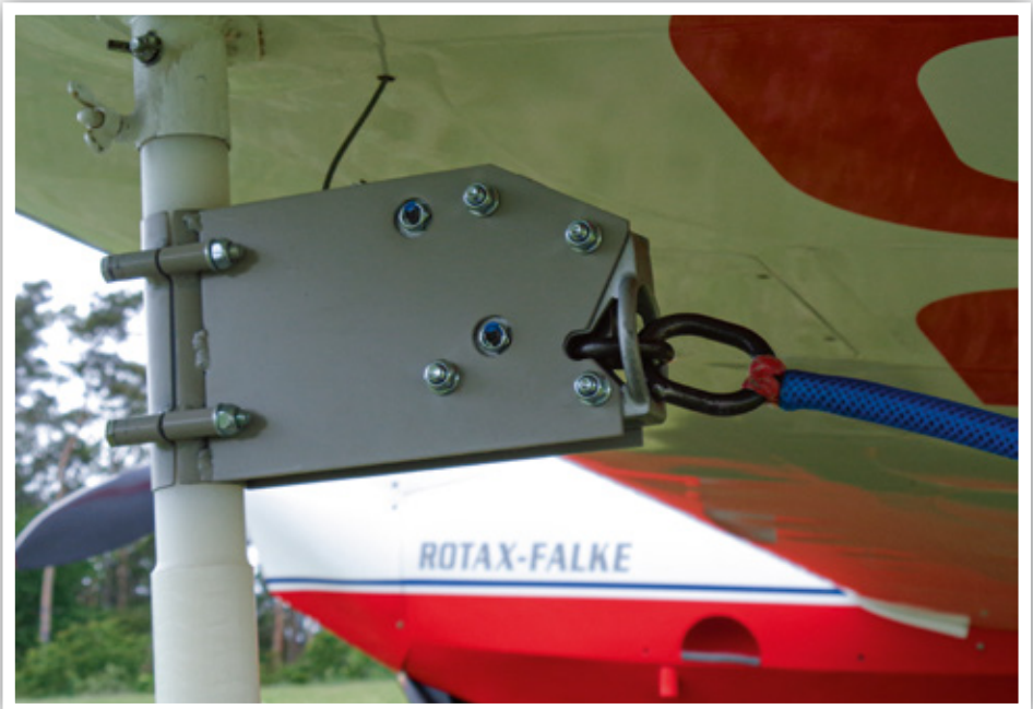
Es wurden Halterungen für die F-Schlepp-Kupplungen hergestellt, die an den Stützradstäben befestigt wurden
