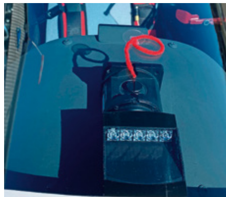
Der Haubenblitzer sitzt ganz vorn an der Haube – durch exaktes Einkleben gibt es keine Spiegelungen oder Sichtbeeinträchtigungen
