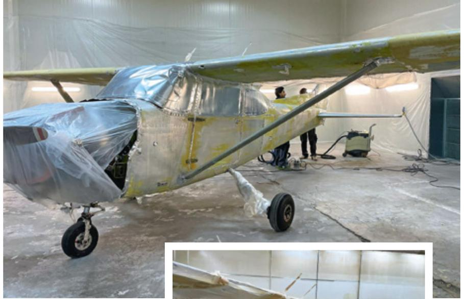
▲ Die Maschine wurde abgebeizt, bevor sie eine neue Lackierung erhielt
