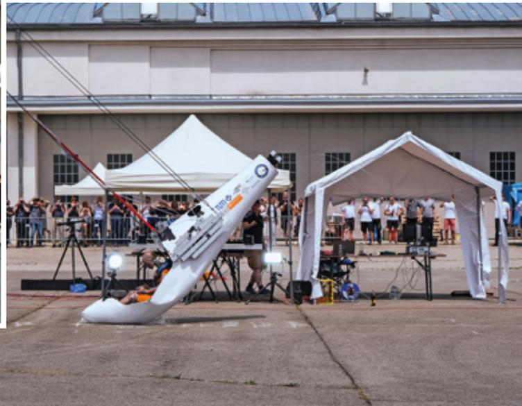
▼ Der Crash wurde von synchronisierten Hochgeschwindigkeitskameras aus verschiedenen Perspektiven gefilmt
