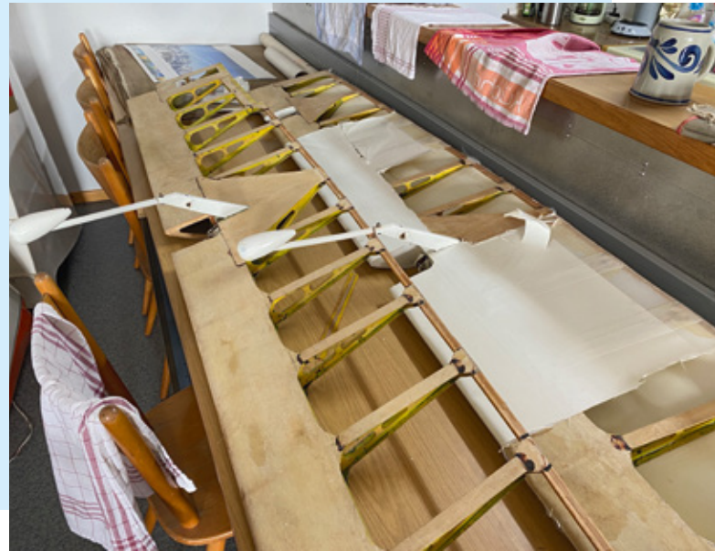
▼ Vorsicht gefragt: Ohne Bespannung zeigt sich der filigrane Aufbau der Tragfläche aus Holz
