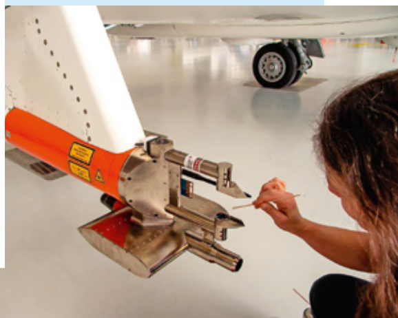
▼ Eispartikelsensor unter der Tragfläche der Falcon 20E
