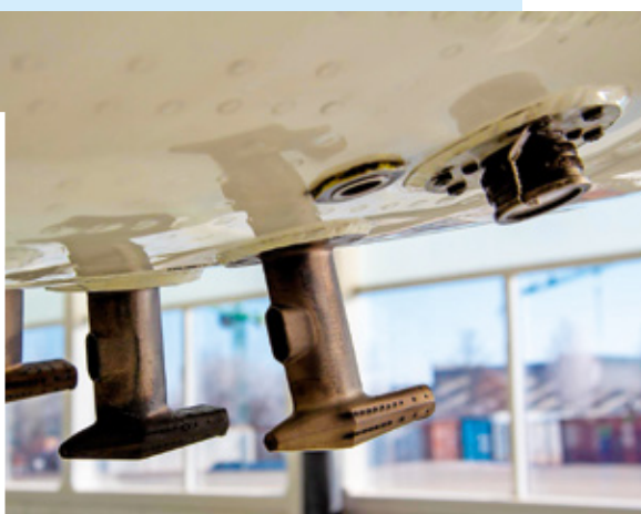
▲ Lufteinlässe unter dem Rumpf der Falcon 20E
