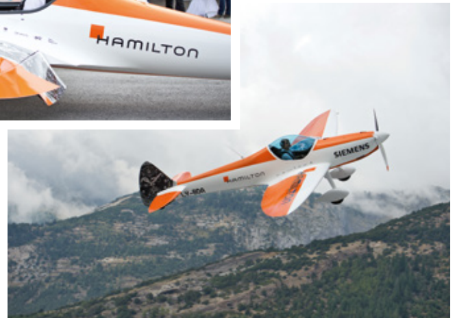
Der Silence Twister Electro ist die erste brauchbare Kunstflugmaschine mit Elektroantrieb
