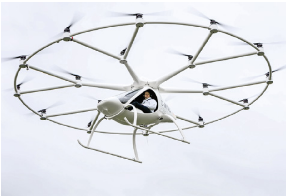
18 Antriebseinheiten sorgen dafür, dass der Volocopter senkrecht starten und auf der Stelle schweben kann
