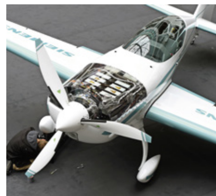
Ein kunstflugfähiges Trainingsflugzeug von Extra Aircraft, das mit einem Elektromotor von Siemens ausgestattet ist, war eine der Neuheiten auf der AERO
