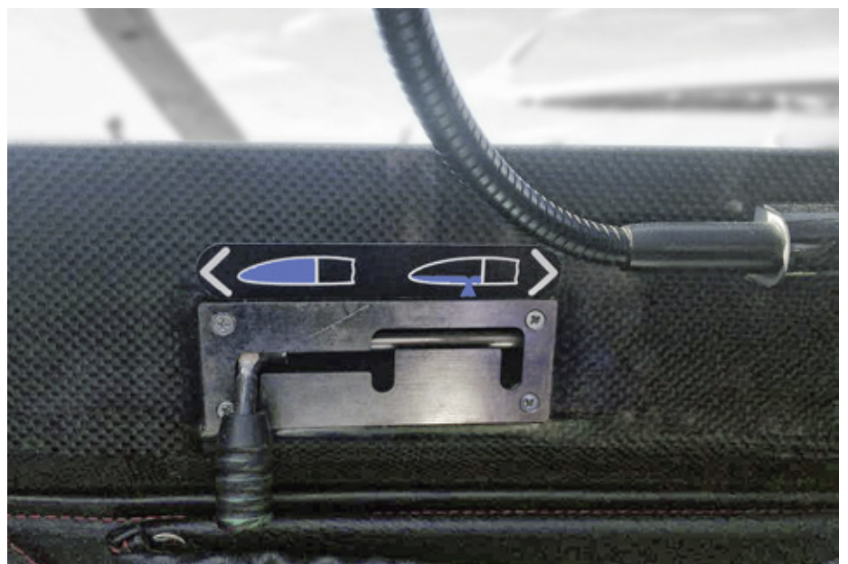
In jedem Flügel sind drei Tanks untergebracht, die in zwei Schritten entleert werden können
