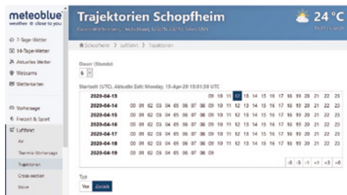
Abbildung 7 Hier wurden die Rückwärtstrajektorien für 12 Uhr UTC für sechs Stunden „zurück“ berechnet (Dauer sechs Stunden, Typ „zurück“). Über dem Standort Schopfheim fährt ein Ballon und ich möchte wissen, wo der Ballon herkommt. Die geschätzte Höhe des Ballons beträgt 500 Meter. Mit Hilfe der Abbildung 8 lässt sich das „Problem“ leicht lösen.
