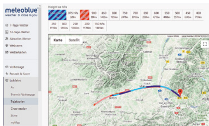
Abbildung 8 Wenn man den Herkunftsort dieses Ballons, der sich gerade über Schopfheim befindet, bestimmen möchte, verfolgt man die Trajektorie 950 hPa (540 Meter geschätzte Höhe) zurück. Bei vorgegebener Fahrtzeit kann man relativ genau den Startort finden.
