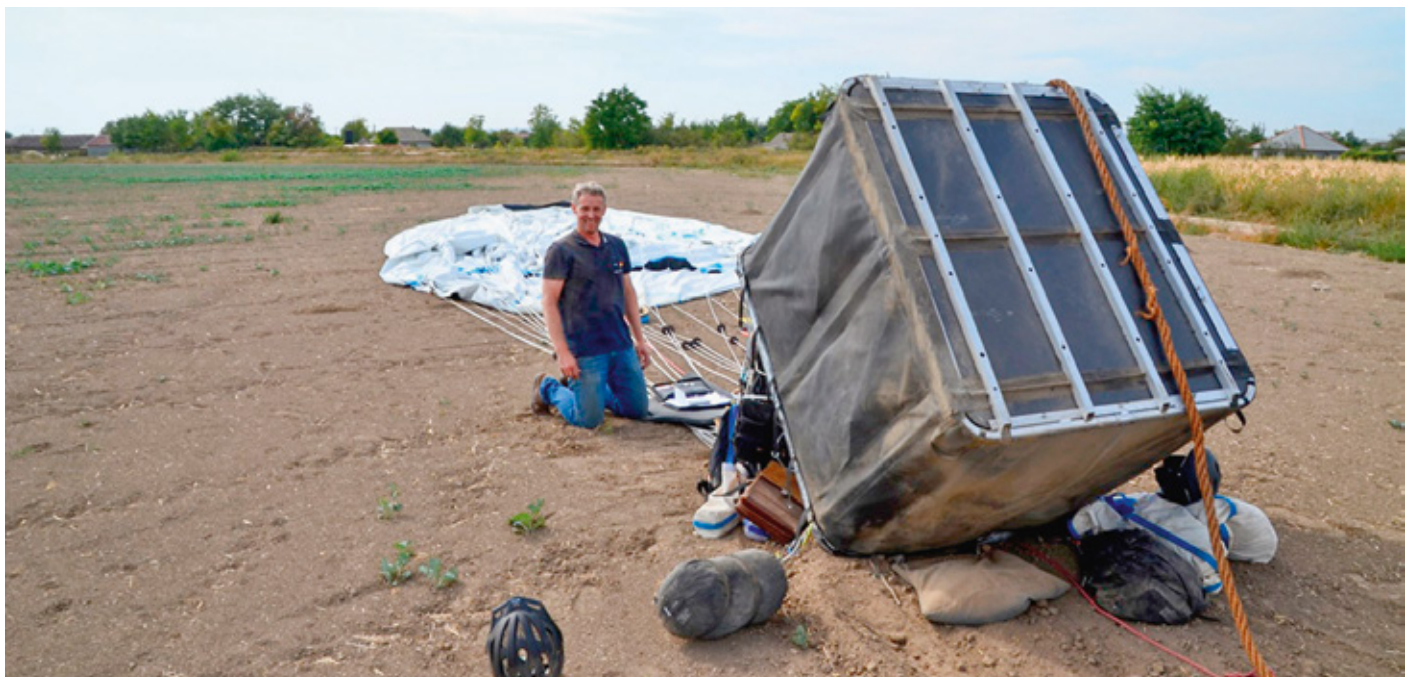
Auch ruppige Landungen meistert der Leichtbaukorb, ein sogenannter Droptest gehörte sogar zur Zulassungsprozedur der EASA
