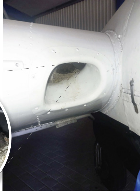
Die Vogelmutter hatte ihr Nest in der Lufteinlassöffnung eines abgestellten Flugzeugs gebaut
