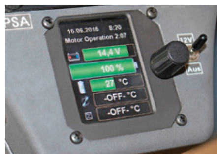
Ein Steuergerät mit Einknopfbedienung im Instrumentenbrett gibt Auskunft über alle wichtigen Parameter wie Ladestand des Akkus, Drehzahl und Temperaturen
