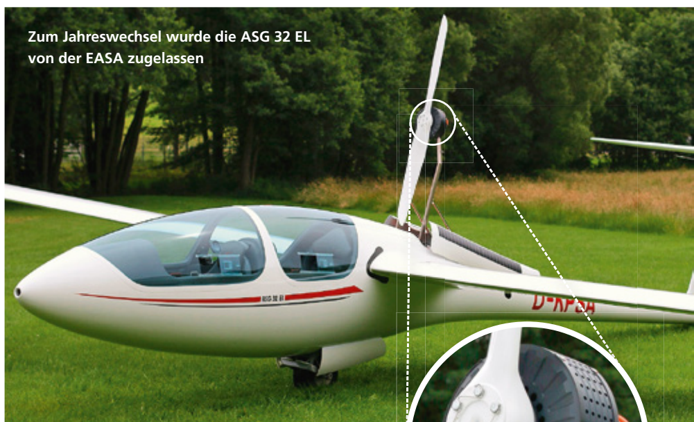
Der 1,55 Meter Propeller wurde eigens für A. Schleicher Segelflugzeugbau entwickelt und dort gefertigt
