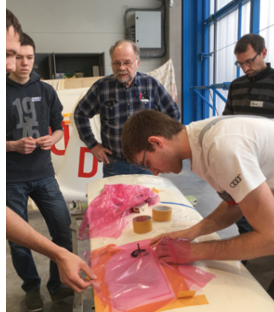
Akaflieger beim Herstellen einer Absaugung
