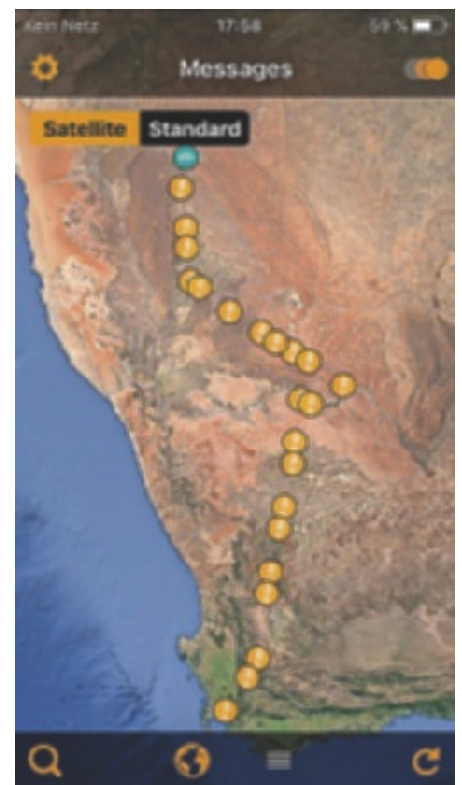
Über den einsamen Wüstengebieten nutzten die Piloten einen SPOT, der alle zehn Minuten eine Positionsmeldung über Satellit abgab
