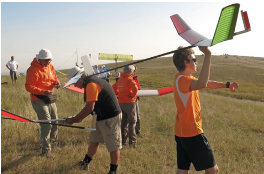
Florian Winker beim Start – das Modell wird mit Schwung nach oben geschleudert und dann durch automatisches Nachdrücken abgefangen und in Gleitflugposition gebracht
