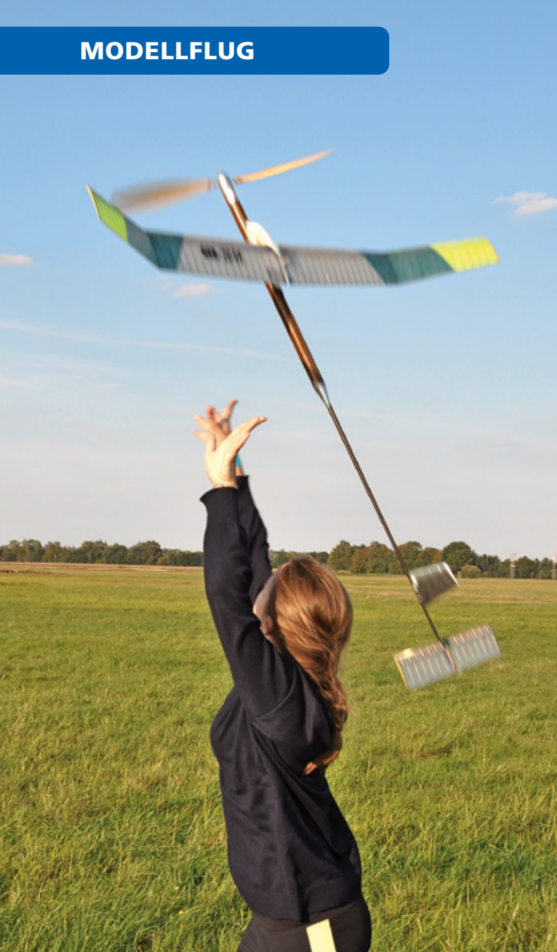
Start eines Gummimotormodells der Klasse F1B: 30 Gramm Gummi bringen das 200 Gramm leichte Modell auf 70 Meter Höhe
