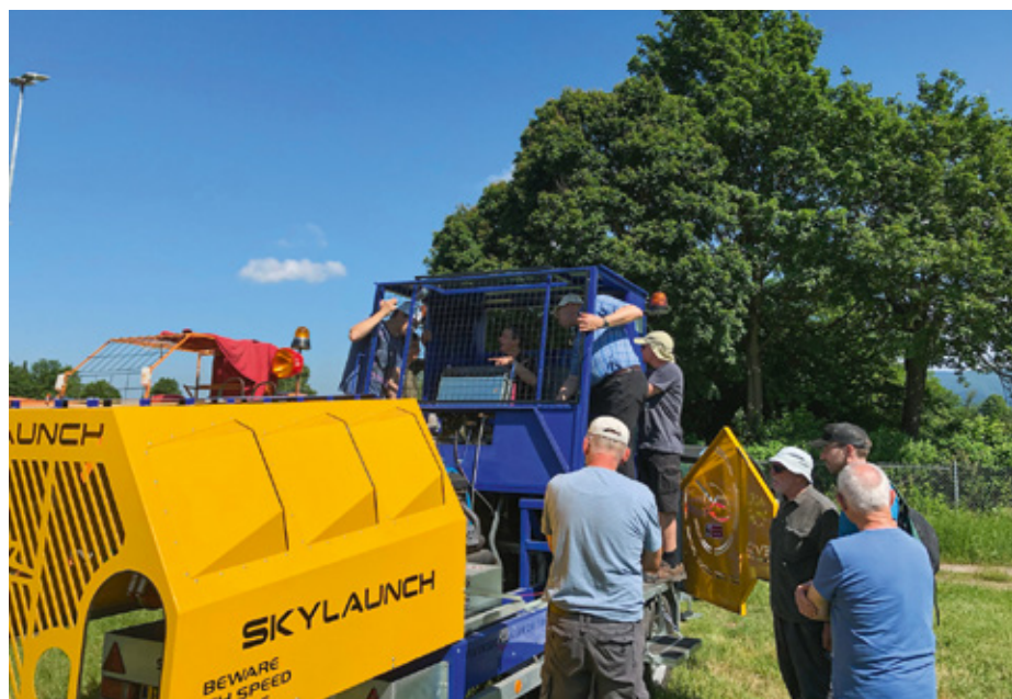
Der Breisgauverein für Segelflug hat eine neue Startwinde, die mit Flüssiggas angetrieben wird
