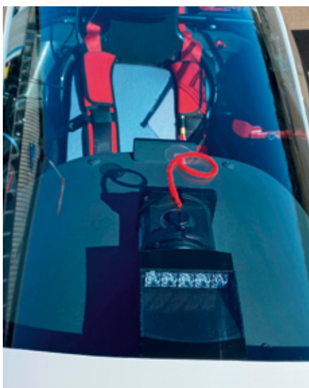
Durch exaktes Einkleben des Haubenblitzers ganz vorn in der Haube gibt es keine Spiegelungen oder Sichtbeeinträchtigungen
