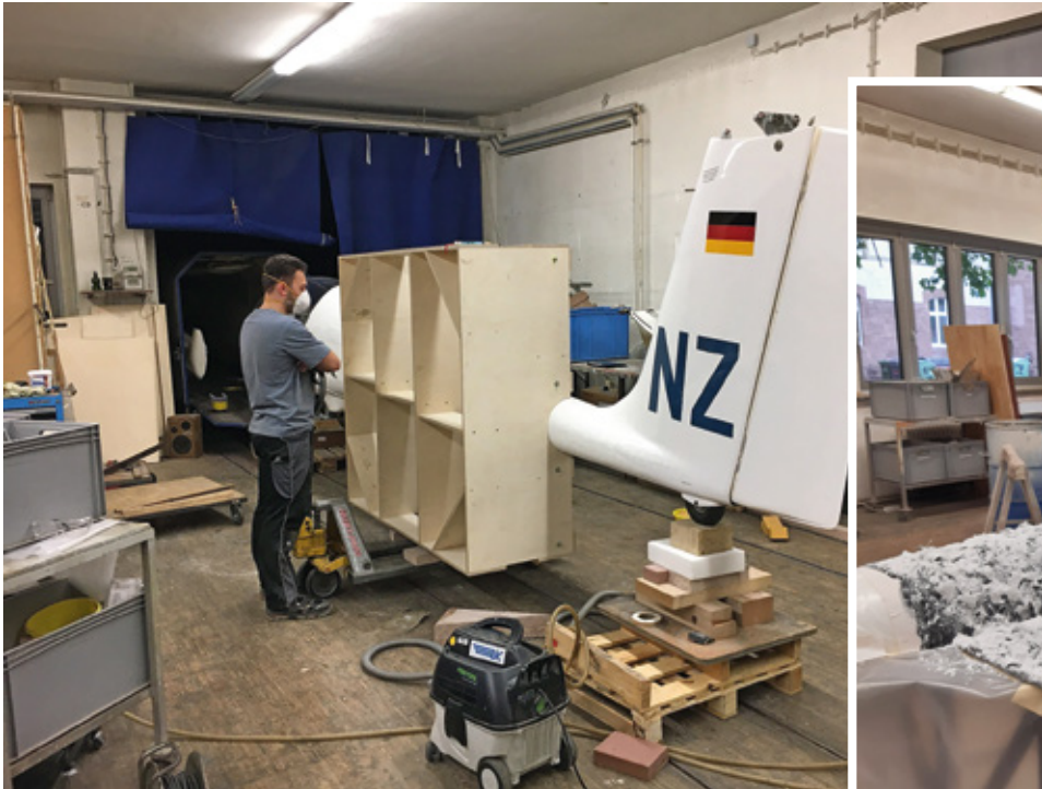
Anpassen der Trennebene an die exakte Längsachse des Rumpfs
