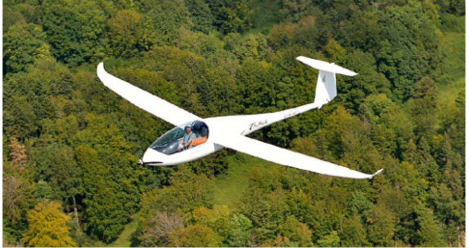
Toni Roth hat aus dem UL-Segelflugzeug Taurus des slowenischen Herstellers Pipistrel eine FES-Variante entwickelt
