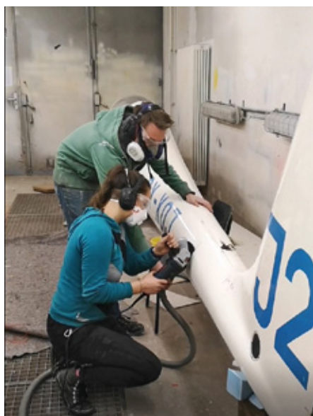
Abtrennen des Leitwerks vom beschädigten Rumpf
