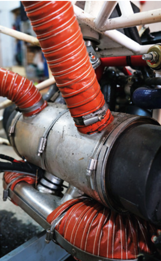
Ein typischer Wärmetauscher bei luftgekühlten Flugmotoren: Dabei wird die Luft, die das Cockpit wärmen soll, um die heißen Bauteile des Abgassystems geführt. Undichtigkeiten im Abgassystem können dabei die spätere Heizungsluft vergiften
