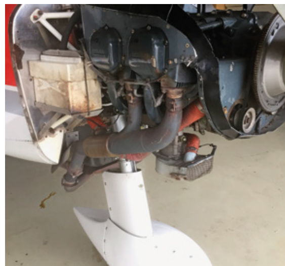
Das Risiko einer Kohlenmonoxid-Vergiftung im Cockpit durch das Abgassystem darf niemals unterschätzt werden
