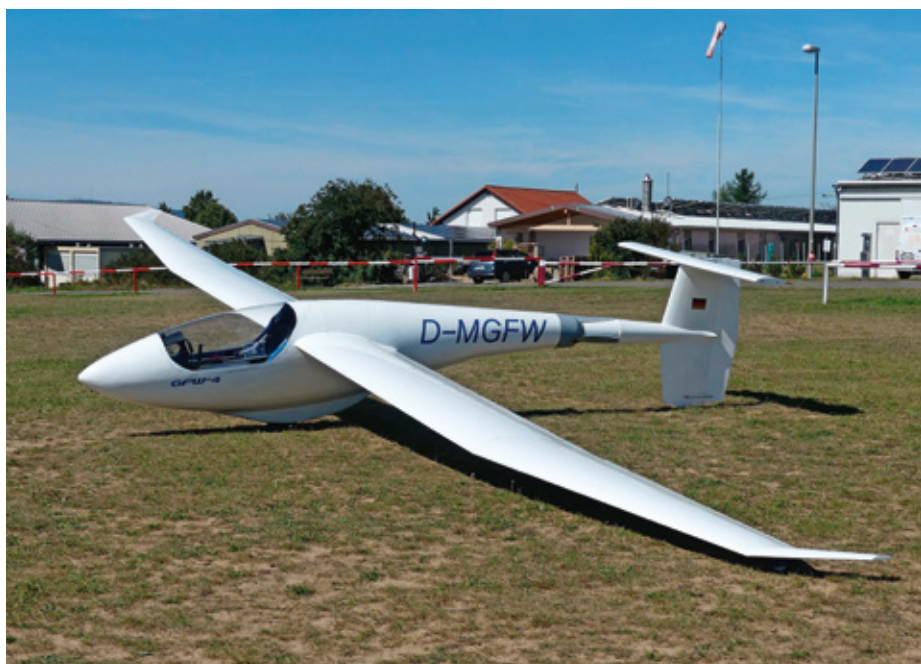
Die GFW-4 gilt als innovativer Ultraleicht-Motorsegler in der 120-Kilogramm-Klasse
