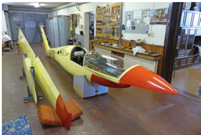
SZD-36A Cobra 15 von Frank-Dieter Lemke. Die Cobra 15 war eines der letzten Hochleistungssegelflugzeuge in Holzbauweise
