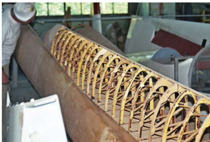
Torsionsnase und linke Tragfläche einer Minimoa Gö 3 im Aufbau. Das Flugzeug ist ein Nachbau und fliegt als PH-80 seit 2011 in den Niederlanden
