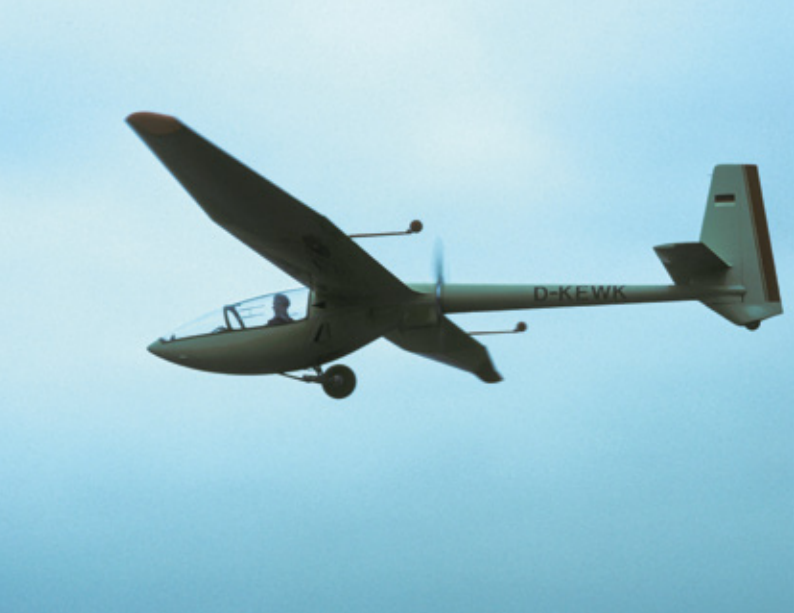
Werner Kuffners WK-1 mit ausgefahrenem Haupttrud und in Strömungsrichtung angelegten Stützrädern in Paderborn-Lipstadt 1984
