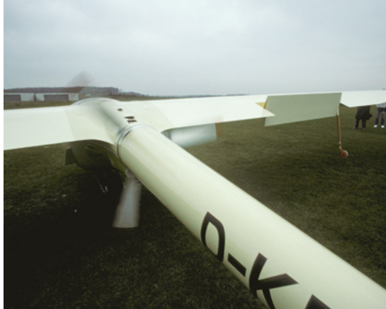
Die WK-1 mit ausgefahrener Hinterkanten-Drehbremsklappe und Dreiblatt-Faltpropeller im Motorlauf
