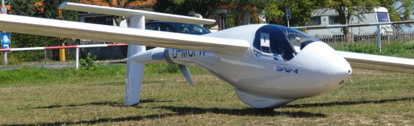
GFW-4, ein ultraleichtes Motorsegelflugzeug der 120-Kilogramm-Klasse
