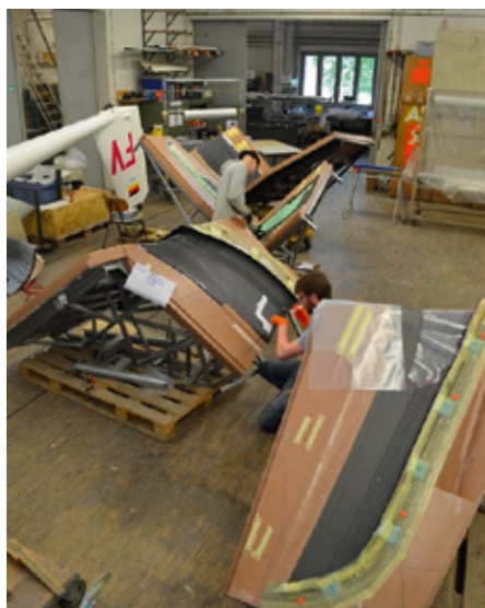
Vier fertige Außenlaminat der Winglets
