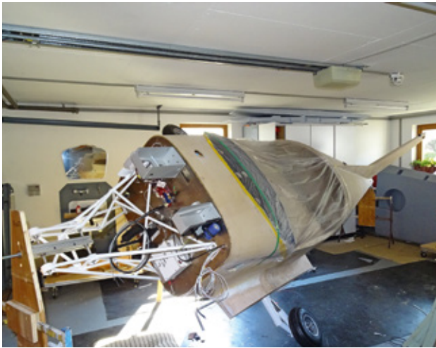
Der Rumpf wurde wie ein Hähnchen auf ein Drehgestell gesteckt und konnte so rundherum bearbeitet werden
