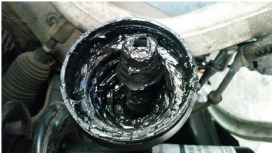
Diese Welle hätte eigentlich im Gelenk im Rad stecken müssen
