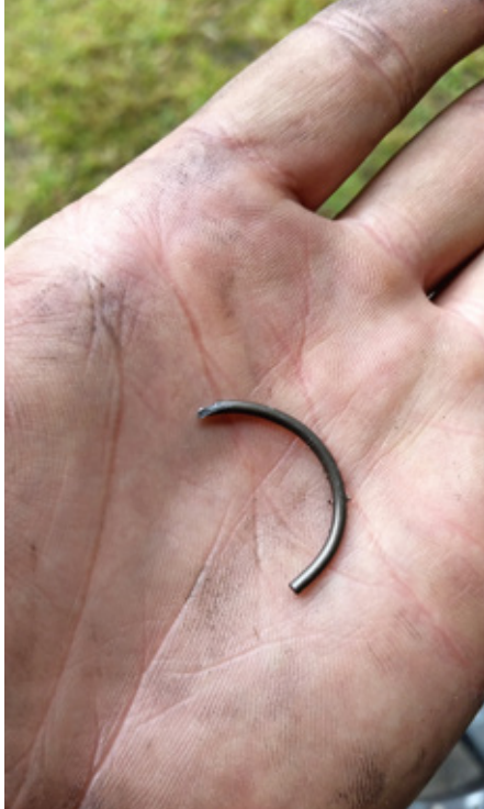
Der Übeltäter: Ein zerbrochener Sicherungsring sorgte für einen unfreiwilligen Zwischenstopp
