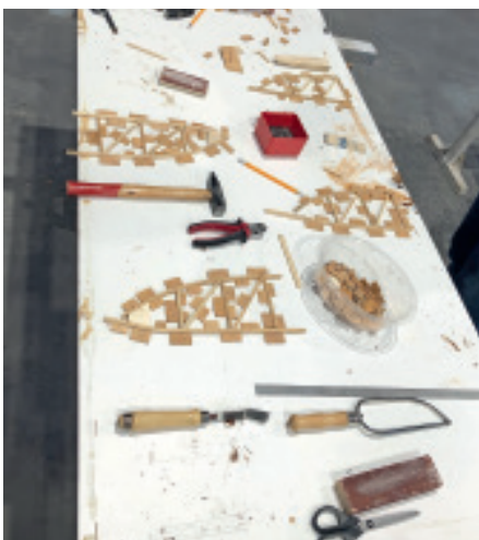
Neue Nasenrippen wurden mittels Klötzchenschablone angefertigt
