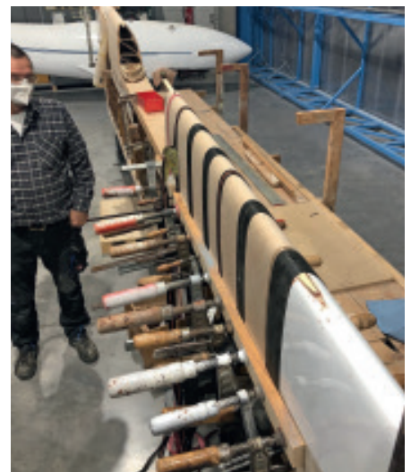
Hier sieht man deutlich, wie viele Zwingen und Gurte benötigt werden, um die Nasenbeplankung mit dem notwendigen Druck auf die Rippen und den Holm zu pressen
