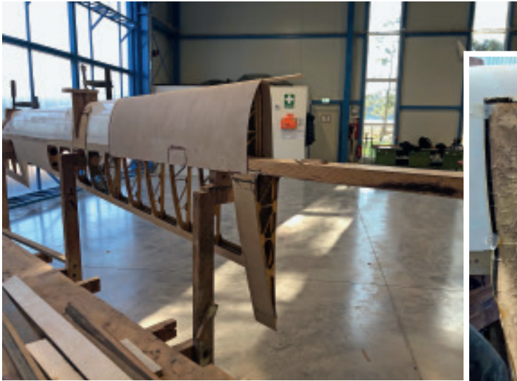
Das Wochenziel wurde erreicht – die Nasenbeplankung sitzt
