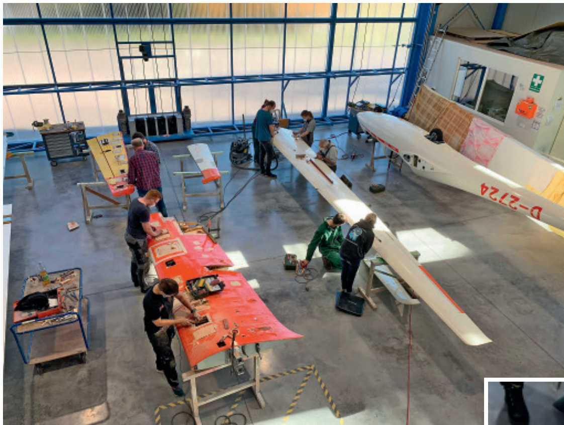
Vakuumieren einer Reparaturstelle
