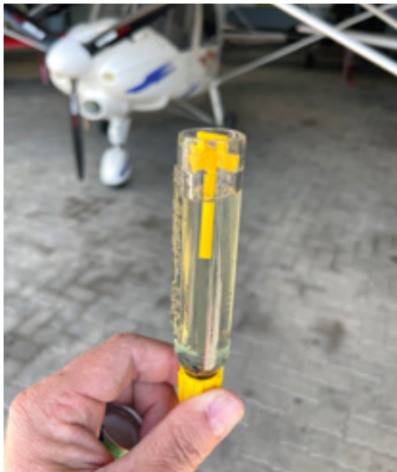
Bild 2: Benzin nach mehrfachem Drainen nach den fünf Monaten Standzeit
