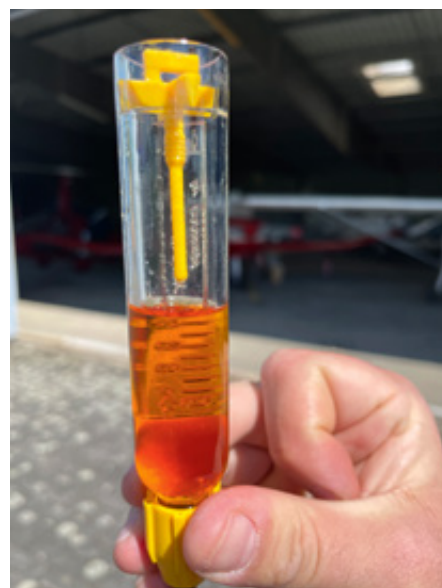
Bild 1: Ups! Vorsichtshalber gedraint, obgleich das Flugzeug eben geflogen ist - nach fünf Monaten Standzeit
