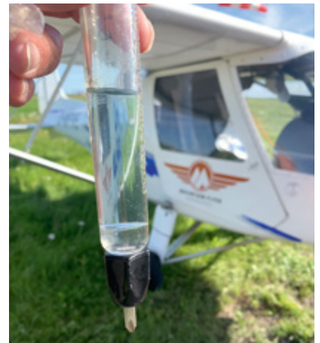
Bild 3: Wasser im Avgas in Klaipeda bei der Vorflugkontrolle
