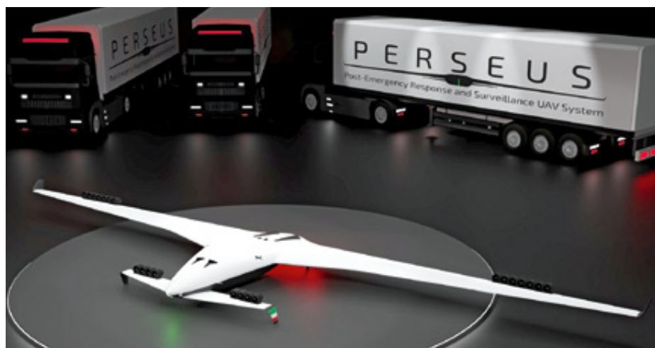
Das Perseus-Konzept der Universität Stuttgart verfügt über ein hybrides Antriebssystem, bestehend aus Wasserstoff-Brennstoffzellen, Batterien und Superkondensatoren
