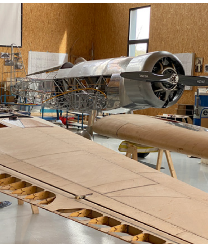
◀ In der Fliegerwerft Wildberg: Die Holzflügel warten auf die Montage
