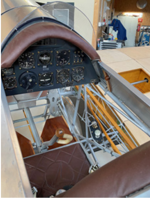
▲ Im Cockpit wurden nur Original-Instrumente verbaut
