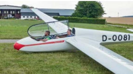
**Kurz vor dem Start: Die für das geplante Experiment mit Wollfäden beklebte rechte Tragfläche ist gut zu erkennen**
