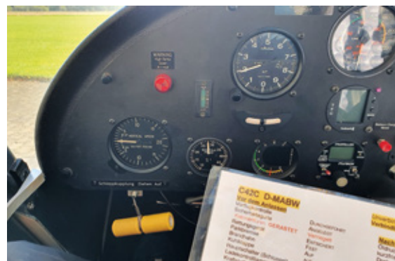
Neben dem Außencheck des Flugzeuges ist auch der Innencheck im Cockpit mit den Instrumenten wichtig
