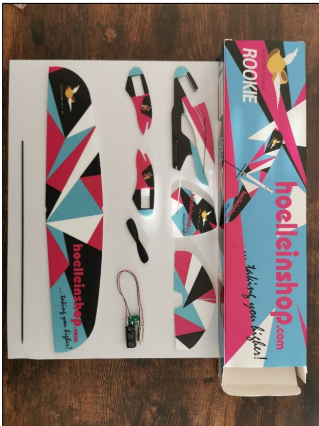
Baukasteninhalt des WSAT Rookies. Auf dem Foto fehlt das Ladegerät
