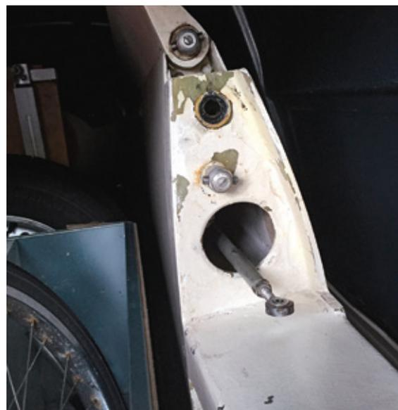
Anschlüsse flächenseitig. Neben den beiden Torsionsanschlüssen sieht man unten den Anschluss des Querruders
