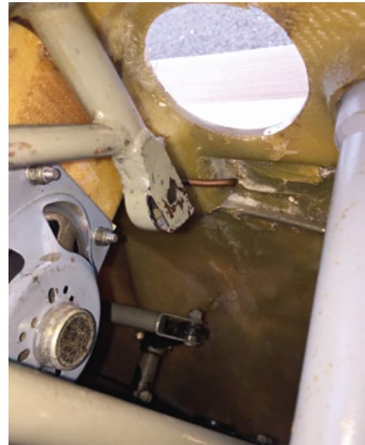
QR-Anlenkung im Rumpf. Wenn die flächenseitige Anlenkung eingeführt ist, wird ein kleiner Federbolzen durch das Loch gesteckt
