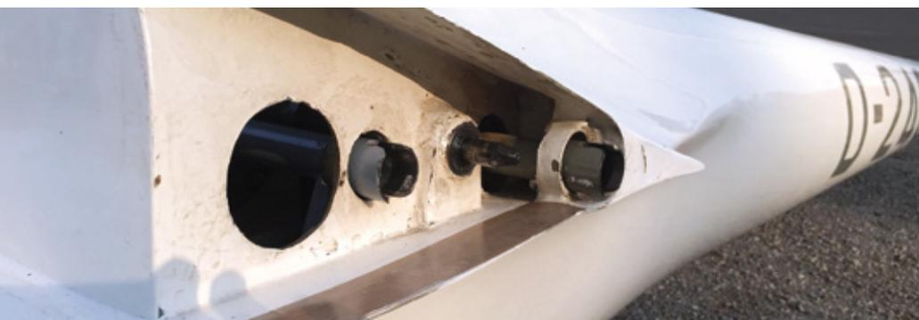
Ruderanschlüsse beim Kestrel. Man sieht gut die beiden Torsionsantriebe für die Anschlüsse der Bremsklappe (vorderer) und Wölbklappe (hinterer)
